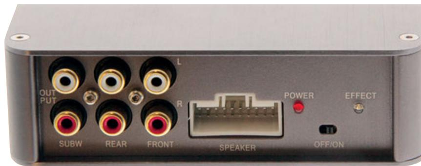
*Su questo pannello ci sono tutti i collegamenti. Le tre coppie di RCA sono uscite destinate a pilotare ampli esterni, compreso quello di un eventuale subwoofer. Il grande connettore multipolare serve al cavo per il collegamento al sistema, una specie di cordone ombelicale che si inserisce tra sorgente e altoparlanti di serie.*
