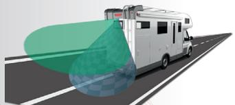
Doppia CAM con angolo di visione video differenziato 140° per il parcheggio e 100° per la visione posteriore durante la marcia
