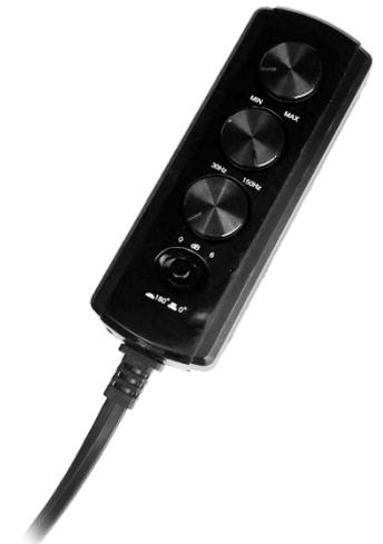
Con l'ausilio del controllo remoto esterno è possibile modificare in tempo reale il livello di uscita audio del subwoofer, regolare il taglio di frequenza, modificare il Bass Boost e all'occorrenza ruotare la fase.
