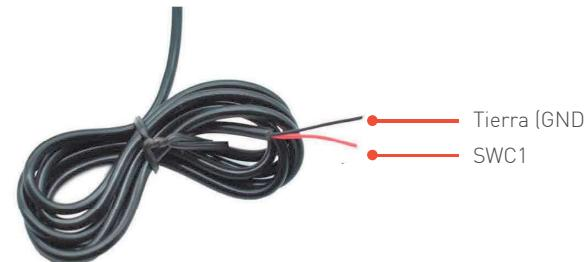
Conecte el cable negro (GND) al cable de entrada del control del volante de la unidad con la indicación SWC GND. Conecte el cable rojo (SWC1) al cable de entrada del control del volante de la unidad de radio marcado como SWC 1. Para aprender las funciones, siga las instrucciones del manual de la unidad de radio.
