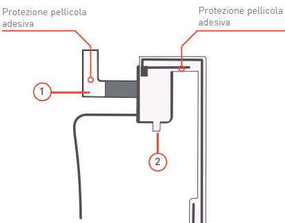
1. Rimuovere la pellicola di protezione dalla lamina per il collegamento di massa e fare pressione sulla stessa per far aderire uniformemente la superficie al montante.
