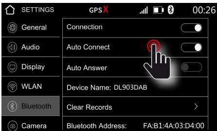
Sous **Connexion automatique**, vous pouvez choisir si votre smartphone doit être automatiquement connecté à l'appareil après un redémarrage.
