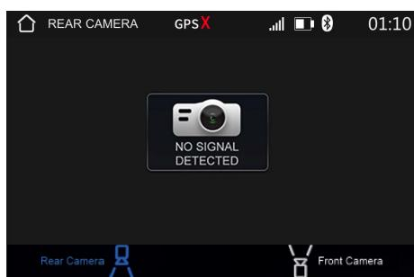
En appuyant sur **Caméra**, vous ouvrez l'affichage de la caméra si vous avez connecté une caméra arrière ou une caméra avant à l'appareil. Si vous avez deux caméras connectées, vous pouvez sélectionner la vue correspondante dans la barre de contrôle en bas.
