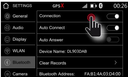
La fonction **Connexion Bluetooth** vous permet d'activer les fonctions de connexion et de réponse du téléphone.
