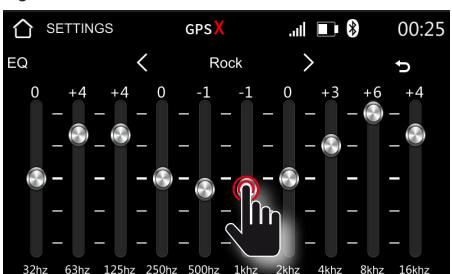
En mode **EQ**, vous pouvez régler manuellement les 10 bandes audio disponibles pour l'égaliseur de -6 dB à +6 dB ou utiliser les boutons < / > pour sélectionner l'un des pré-réglages :
