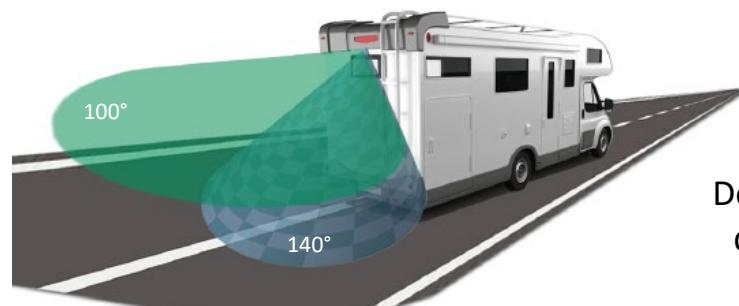
Doble cámara con ángulo de visión diferenciado de 140° para el estacionamiento y 100° para la visión trasera durante la marcha.
