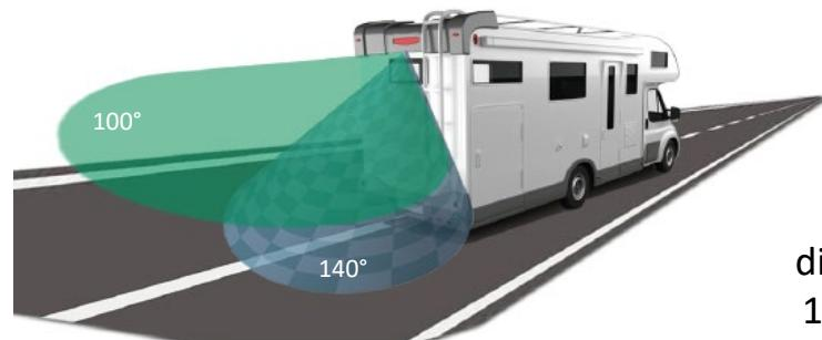
Double caméra avec angle de vision vidéo différencié de 140° pour le stationnement et de 100° pour la vision arrière pendant la conduite.
