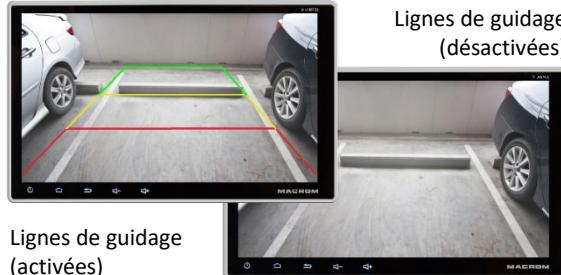
L'aide au stationnement peut être facilitée par l'activation des lignes de guidage.
