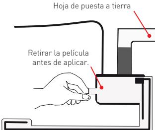
Retire la lámina de soporte del amplificador negro y de la antena laminada y pegue la antena a la ventana. Pegue la superficie metálica de color cobre de la lámina de conexión a tierra a una parte metálica desnuda del vehículo.
