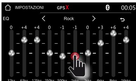
En el modo **EQ**, puede ajustar manualmente las 10 bandas de audio disponibles en el ecualizador de -6dB a +6dB, o utilizar los botones ⏪ / ⏩ para seleccionar uno de los preajustes: Off (Flat), User, Jazz, HipHop, Pop, Rock, R&B.
