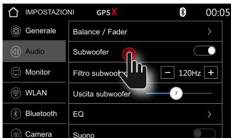
**Subwoofer** activa las salidas previas SUB1/SUB2. La frecuencia de corte se puede ajustar en la sección Filtro Subwoofer, es decir, se filtran todas las frecuencias superiores.
