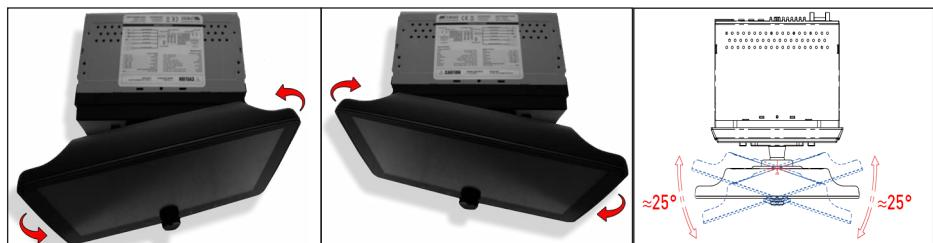
**INCLINACIÓN HORIZONTAL:** Sujetando firmemente los laterales de la radio y aplicando una ligera presión en el lado derecho o izquierdo, es posible inclinar horizontalmente el monitor hasta un máximo de 25°.
