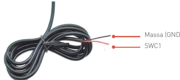
Collegare il cavo Nero (GND) al cavo di ingresso del comando al volante della unità radio con indicazione SWC GND. Collegare il cavo rosso (SWC1) al cavo di ingresso del comando al volante della unità radio con indicazione SWC 1. Per effettuare l'apprendimento delle funzioni, seguire le istruzioni riportate sul manuale della unità radio.
