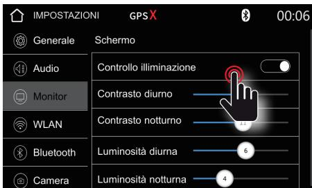
Con il **Controllo Illuminazione** puoi attivare la funzione di controllo per la modalità luce diurna e luce notturna tramite il trigger dei fari connesso.
