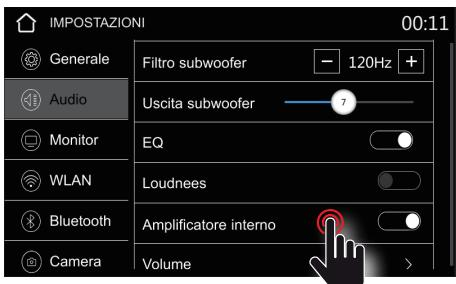
Nella sezione **Amplificatore interno** puoi attivare o disattivare l'amplificatore audio integrato del dispositivo.
