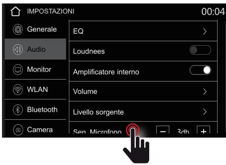
Nella sezione **Livello Microfono** puoi regolare il volume del microfono vivavoce con i pulsanti -/+.
