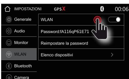
Nella sezione **WLAN** puoi attivare o disattivare la funzione Wi-Fi. Questa funzione è necessaria per Apple CarPlay e Android Auto.
