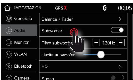
**Subwoofer** attiva le pre-uscite SUB1/SUB2. La frequenza di taglio può essere impostata nella sezione Filtro Subwoofer, ossia tutte le frequenze superiori vengono filtrate.
