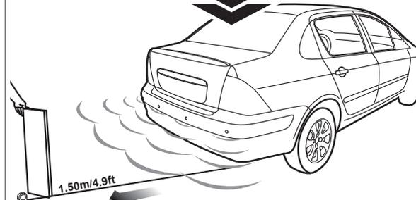
Il test di funzionamento si effettua tenendo una tavola di legno (0,3m x 1,0 m) dietro il veicolo e procedendo lentamente in retromarcia per testare tutte le funzioni come indicato sul manuale del prodotto
