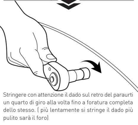
Stringere con attenzione il dado sul retro del paraurti un quarto di giro alla volta fino a foratura completa dello stesso. (più lentamente si stringe il dado più pulito sarà il foro)
