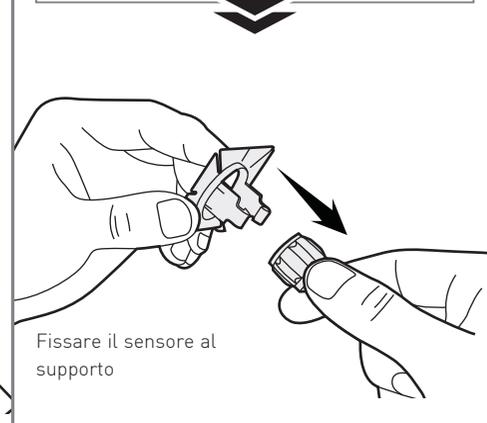
Fissare il sensore al supporto
